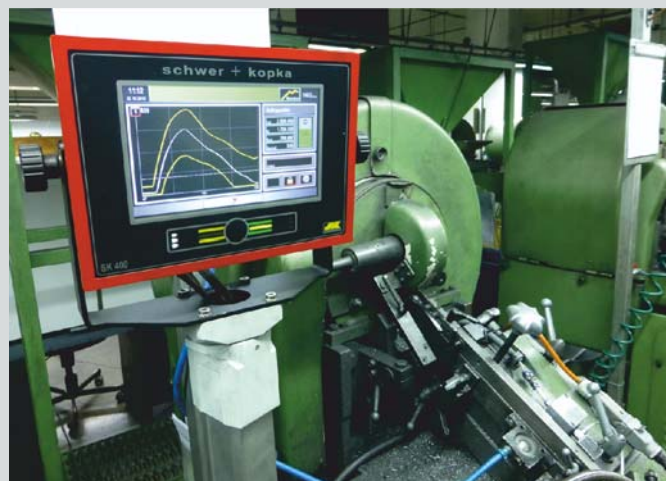
Überwachungssystem SK 400 an einer E. W. Menn Rundwalzmaschine
